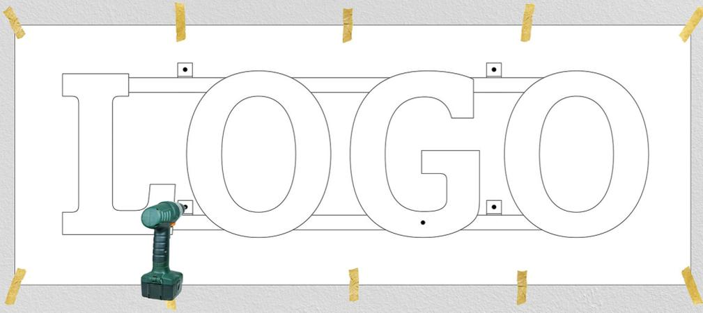
Befestigen Sie die 1:1 Zeichnung mit etwas Klebeband an der Wand und bohren Sie die Löcher durch die Zeichnung in die Wand. Dies sind die Löcher für die Befestigung.
