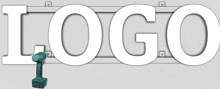
Befestigen Sie den Montagerahmen mit geeigneten Schrauben und Dübeln.
