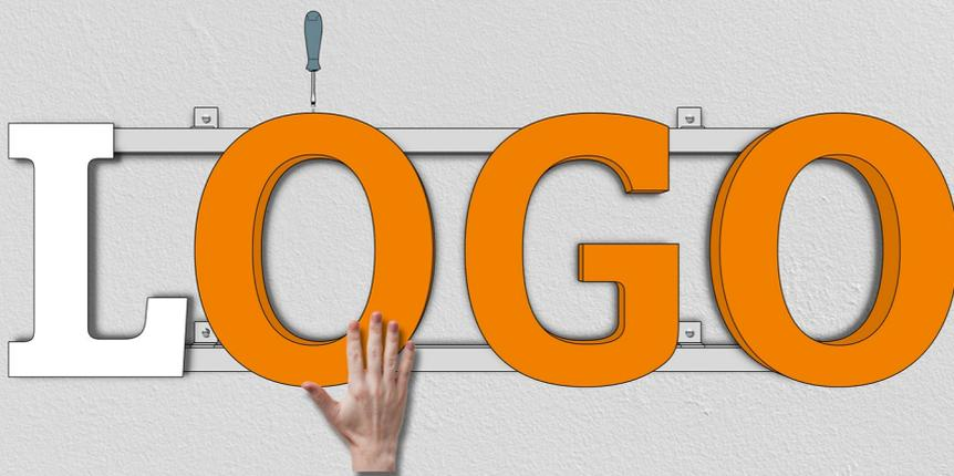
Setzen Sie die Reliefbuchstaben auf und verschrauben Sie diese mit den beiliegenden Schrauben in die Buchstabenböden.
