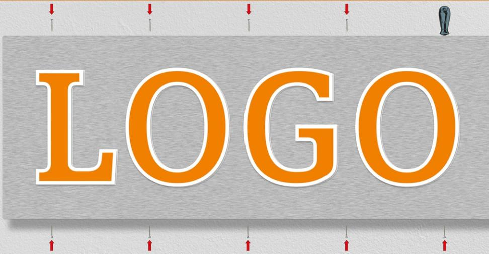
Verschrauben Sie die Frontblende durch die vorgegebenen Löcher mit der Grundplatte.
