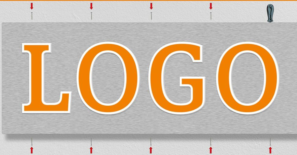
Verschrauben Sie die Frontblende durch die vorgegebenen Löcher mit dem Unterkasten.
